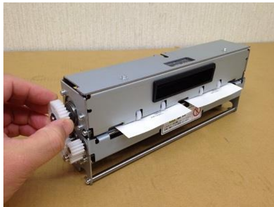
スリッターユニットの紙除去
