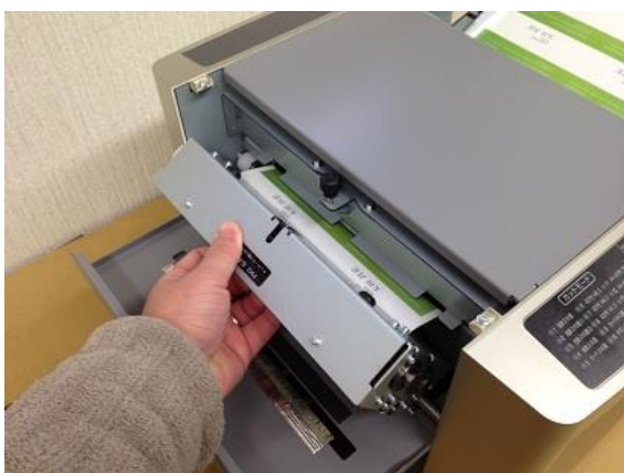
スリッターユニット取り外し
