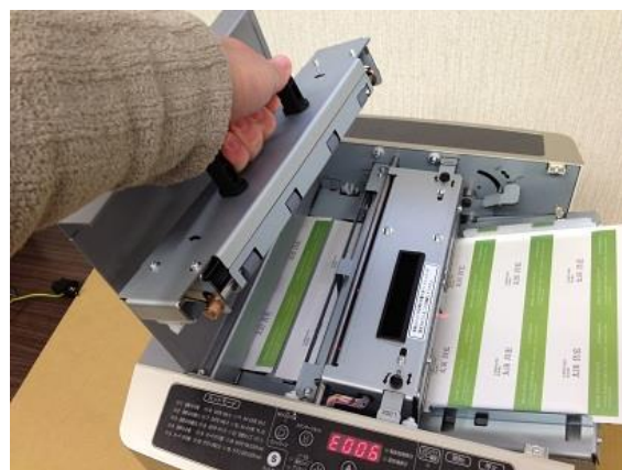
加圧ユニット取り外し
